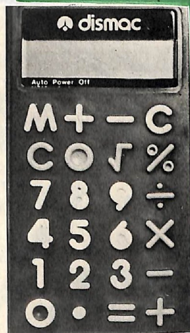
Calculadora DISMAC ABACUS (colorida) — tem oito dígitos, faz as quatro operações fundamentais e calcula porcentagem
